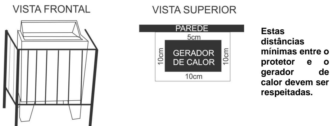
Figura 9: Posicionamento do protetor em U – linha STAR
